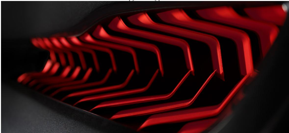
**Οι οργανικές φωτοδίοδοι ή OLED είναι καινοτόμες, αποδοτικές και βιώσιμες πηγές φωτός. Στις OLED, το φως εκπέμπεται από στρώματα ημιαγωγών (πάχους όσο ένας δίσκος ολοκληρωμένου κυκλώματος) από οργανικά υλικά.**
