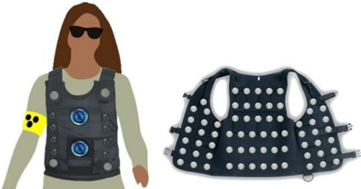
Το Eyeronman είναι εφοδιασμένο με μια ευρεία γκάμα αισθητήρων, όπως το σύστημα lidar (είδος ραντάρ λέιζερ που χρησιμοποιείται και στα αυτόνομα οχήματα χωρίς οδηγό, υπερήχων και υπέρυθρων ακτίνων που ανιχνεύουν τη θερμοκρασία των σωμάτων.
