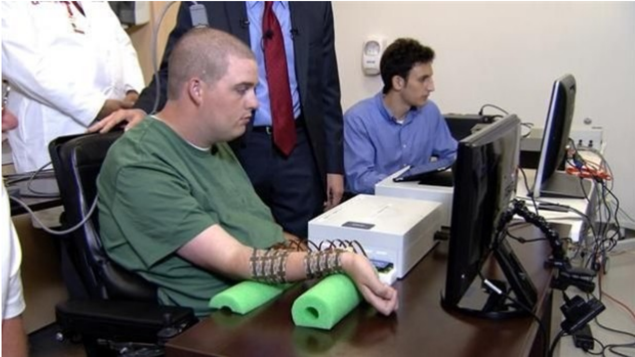
Το τσιπ συνδέεται μέσω καλωδίου με τα ηλεκτρόδια που φορά ο Ίαν στο χέρι. Credit: (CBS News)
