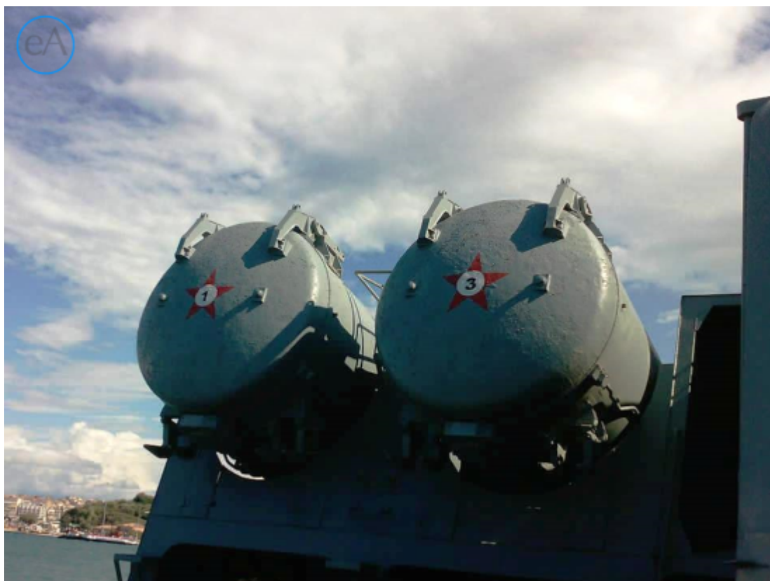
Το πρώτο ζευγάρι βλημάτων P-500 (SS-N-12 Sandbox) της δεξιάς πλευράς. Τα βλήματα αυτά έχουν εμβέλεια 550χλμ., ταχύτητα 2,5 Mach και πολεμική κεφαλή
