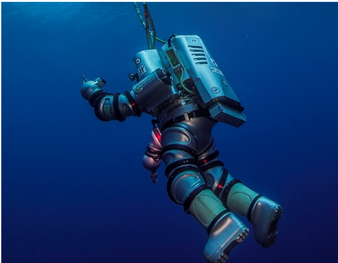
Κατάδυση του ρομποτικού σκαφάνδρου μίας ατμόσφαιρας Exosuit
