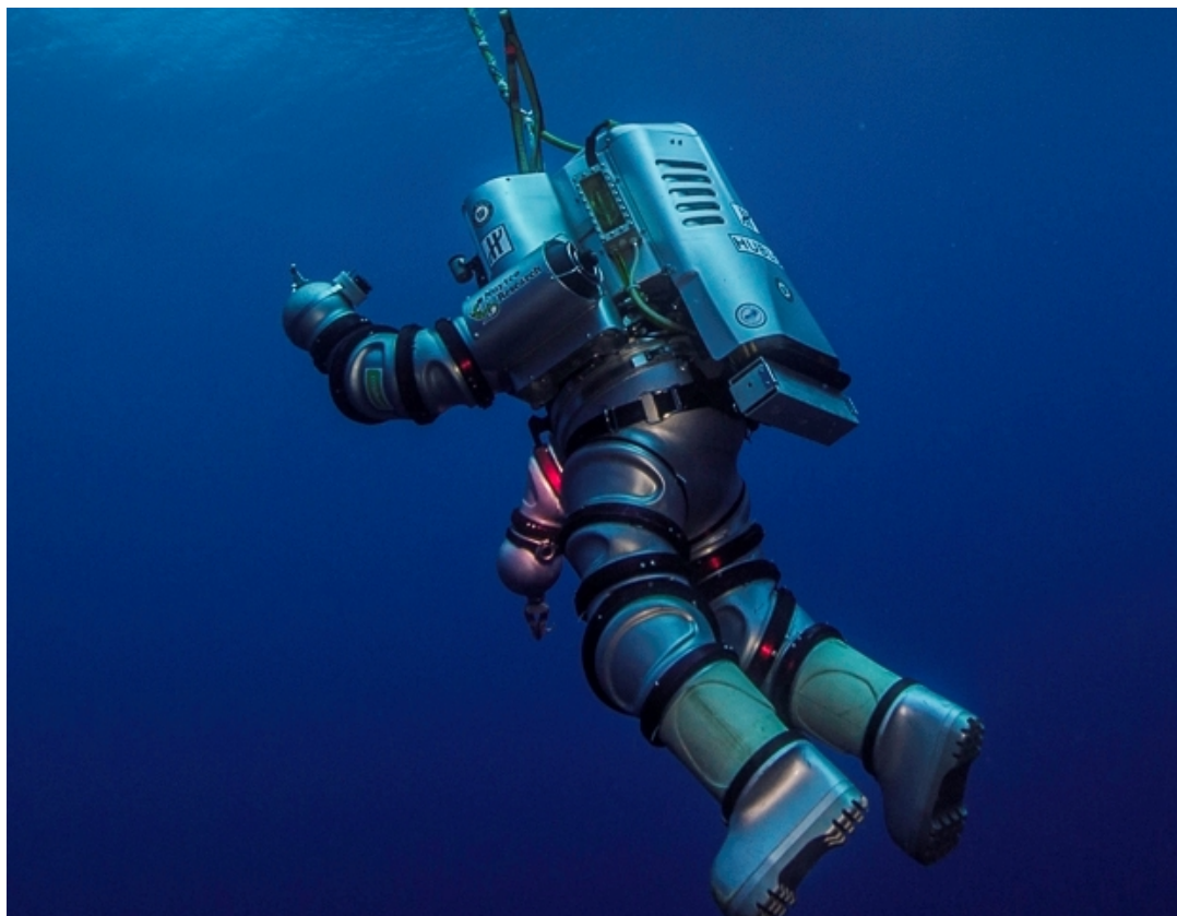
Κατάδυση του ρομποτικού σκαφάνδρου μίας ατμόσφαιρας Exosuit
