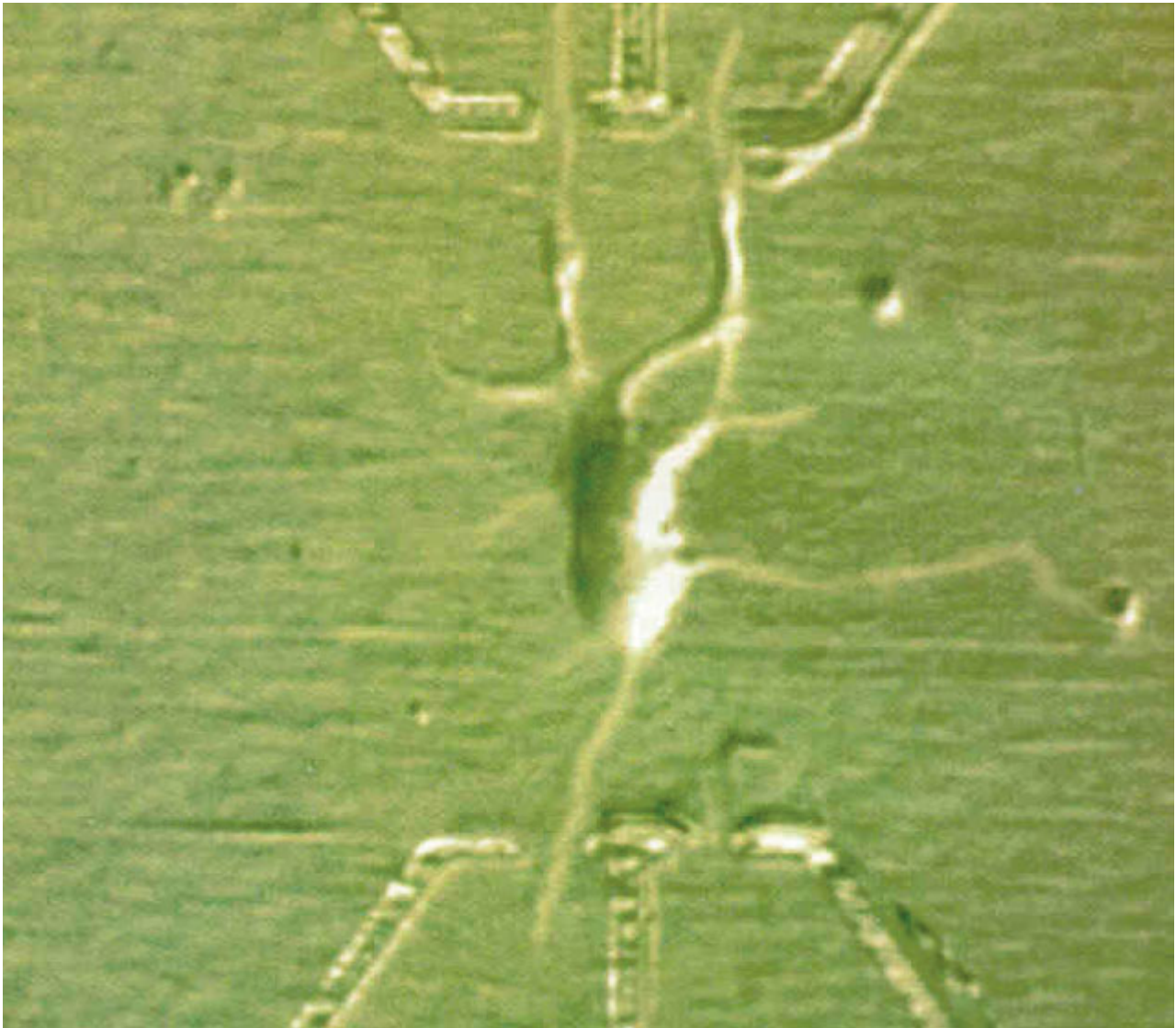
Συνδεσμολογία ενός νευρώνα ποντικού με νανοκαλώδια και η δημιουργία ενός βιοηλεκτρονικού αισθητήρα συστήματος.
