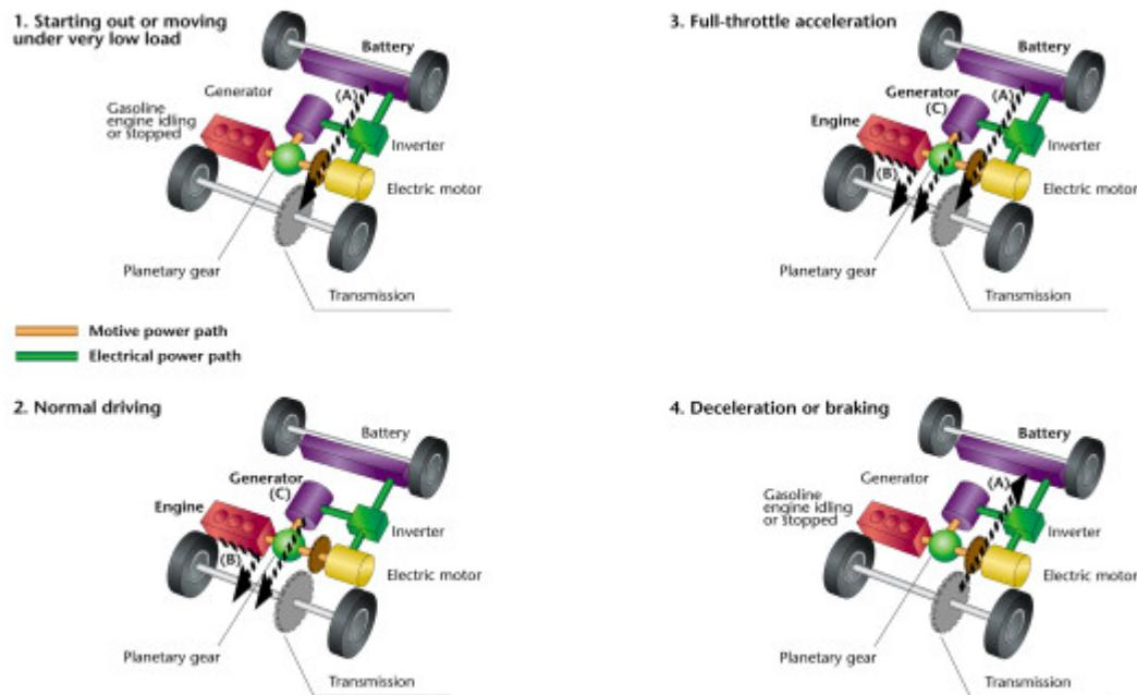
Με αυτό το πλήρως υβριδικό σύστημα, ένα αυτοκίνητο μπορεί να λειτουργεί είτε με έναν πολύ αποδοτικό και χαμηλών εκπομπών ρύπων βενζινοκινητήρα ή με τον ηλεκτροκινητήρα, ή με ένα συνδυασμό και των δύο. Η αναλογία ισχύος που παρέχει το κάθε σύστημα καθορίζεται συνεχώς από ένα ηλεκτρονικό υπολογιστή, ανάλογα με την ταχύτητα και το φορτίο ώστε να διασφαλίζεται το πιο αποδοτικό πρόγραμμα λειτουργίας.
