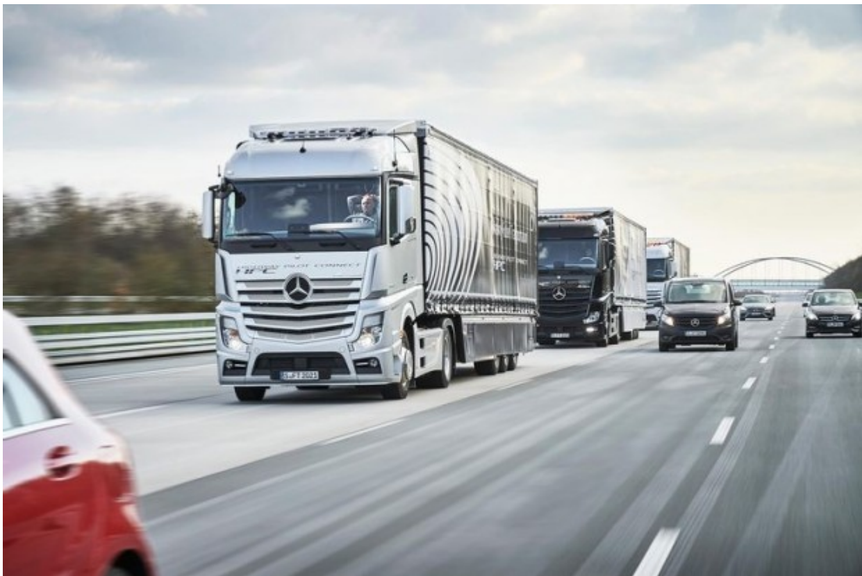
Mercedes-Benz Actros Lkw nutzen das System Highway Pilot Connect zur vernetzten Fahrt im Verbund (Truck Platoon)
