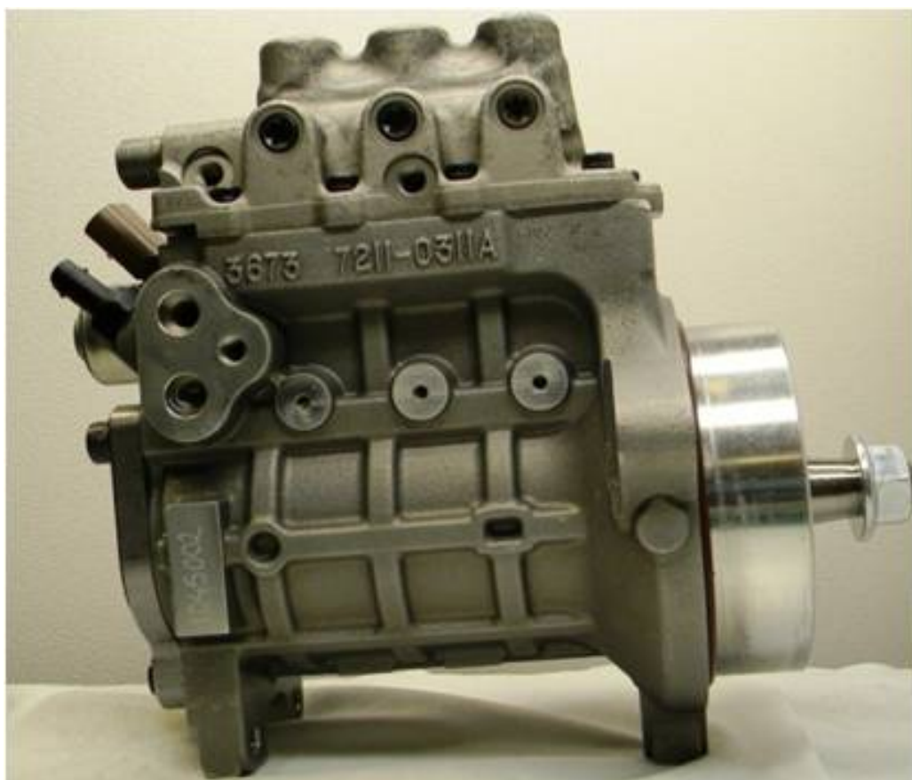
Η αντλία υψηλής πίεσης είναι βασισμένη σε αντλία common rail HD της Delphi, που χρησιμοποιείται σε πετρελαιοκινητήρες (δουλεύει με πίεση μέχρι 2.400 bar) και έχει υποστεί τις αναγκαίες τροποποιήσεις, όπου αυτό ήταν απαραίτητο, προκειμένου να λειτουργήσει χωρίς πρόβλημα με DME.
