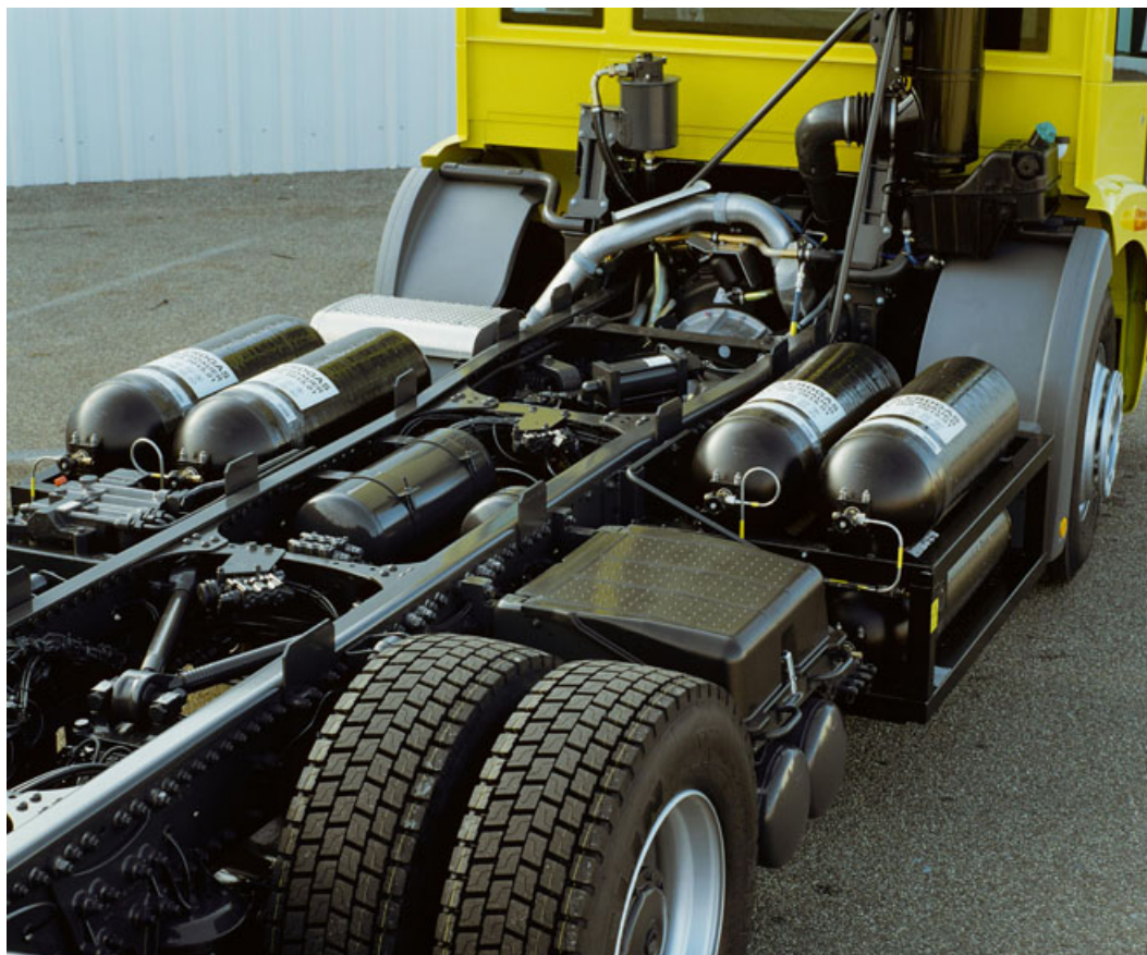
Φορτηγό φυσικού αερίου. Εδώ οι μπουκάλες τοποθετούνται σε ειδικά πλαίσια, αναρτημένα στο σασί.
