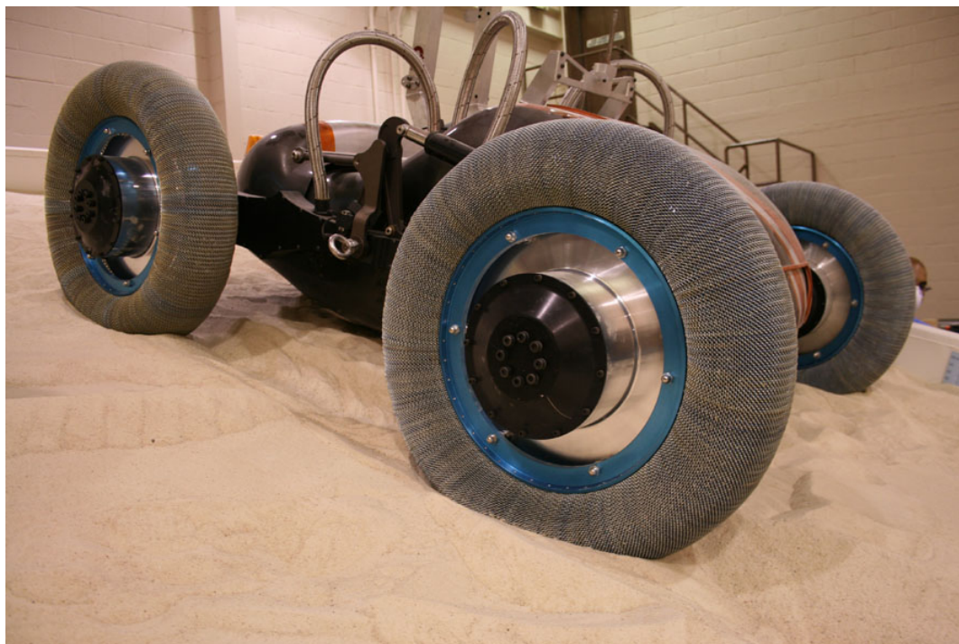
Το όχημα επιφανείας SCARAB με ελαστικά Goodyear Spring στο ερευνητικό κέντρο Glenn της NASA
