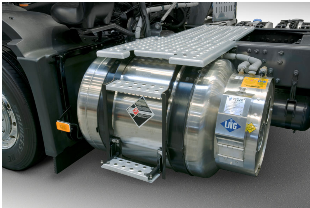
Ρεζερβουάρ υγροποιημένου φυσικού αερίου
