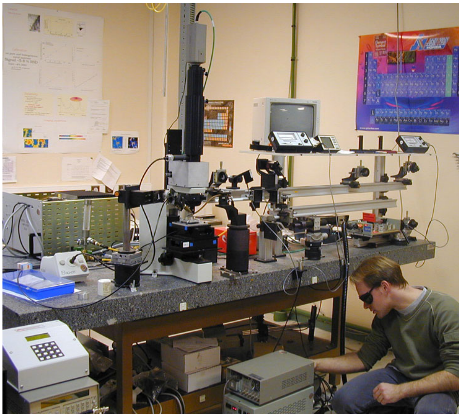
Οι τεχνικές LA-ICPMS και LIBS βασίζονται στην επίδραση φωτονίων από lasers στην επιφάνεια των δειγμάτων και στην μικροποσότητα του δείγματος, που δεν είναι ορατές με γυμνό μάτι.
